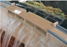
FRANCE | Cammazes - Scale: 1:35 Free surface spillway - 4 bays
