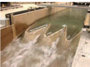
OMAN | Wadi Aday - Scale: 1:40 Labyrinth flood spillway
