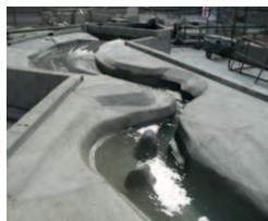
Brazil | Sedimentological model of Jirau Horizontal scale: 1:1000 - vertical scale: 1:100
