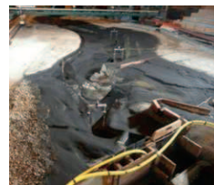
Brazil | Sedimentological model of Jirau Horizontal scale: 1:1000 - vertical scale: 1:100
