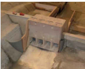
OMAN | New Fulajj Dam - Wadi Rafsa Scale: 1:50 Bottom gates
